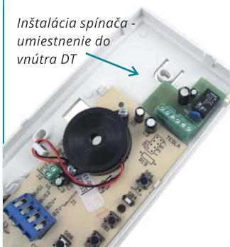
K spínaču sa pripája domáci telefón a vysielač bezdrôtového zvončeka, t.j. zvončekové tlačidlo. Vyzvonením domáceho telefónu z elektrického vrátnika alebo iného domáceho telefónu (interkomové volanie) zopne spínač kontakty pripojeného zvončekového tlačidla. Zvončekové tlačidlo následne vyšle kód príjímaču bezdrôtového zvončeka, na základe ktorého bude vyzvávať súčasne s domácom telefónom. Zdvihnutím slúchadla domáceho telefónu sa zruší vyzvávanie na telefóne i zvončku.
