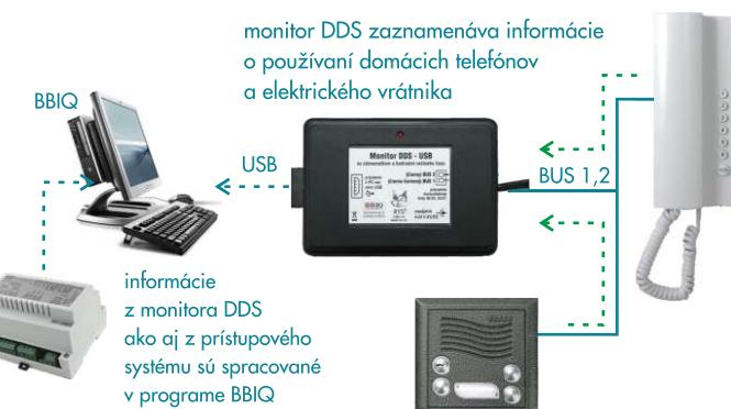
Monitor DDS - USB umožňuje off-line aj on-line záznam udalostí. Kapacita off-line záznamníka je 3276 udalostí. V on-line režime môže byť pripojený len 1 Monitor DDS - USB v systéme (cez USB priamo do PC).
